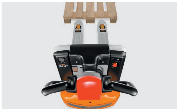
La struttura ribassata del transpallet favorisce la visuale sulle punte delle forche
