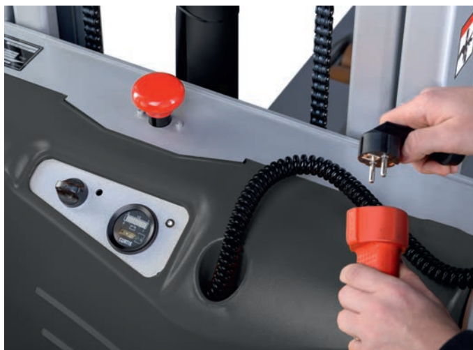
Il caricabatteria integrato assicura la massima semplicità durante le operazioni di ricarica
