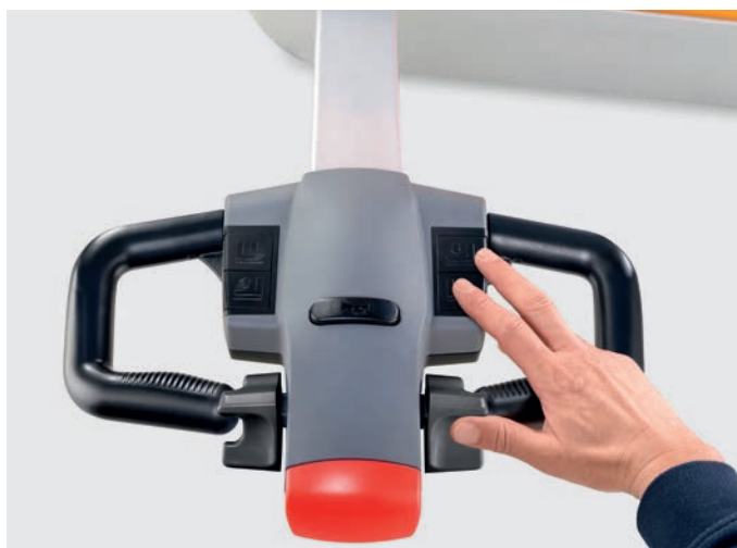
Timone di comoda impugnatura per operatori sia mancini sia destrorsi
