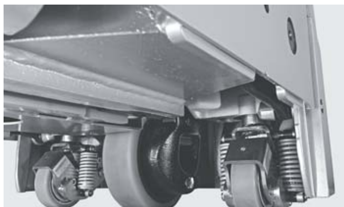
Potente trazione sulle rampe grazie ai rulli di supporto caricati a molla per una marcia ottimale in ogni momento
