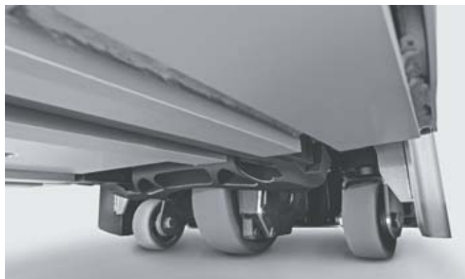
Su e giù per la rampa: trazione ottimale in ogni situazione grazie alla sospensione idraulica della ruota di supporto
