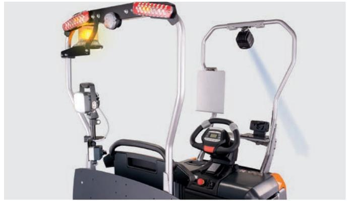
Staffa per accessori opzionali per molteplici possibilità d'uso e varianti di dotazione con lampeggiante e fari di lavoro<sup>2</sup>
