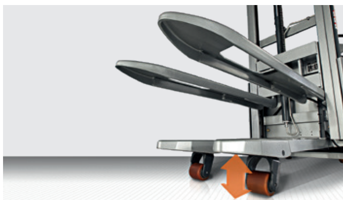
Il sollevamento iniziale (opzionale) lascia più spazio a terra sulle superfici irregolari
