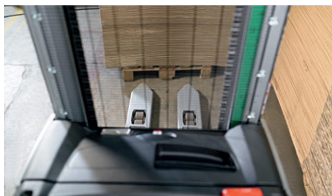
Il montante STILL a vista libera garantisce sempre la migliore visibilità sulla punta delle forche
