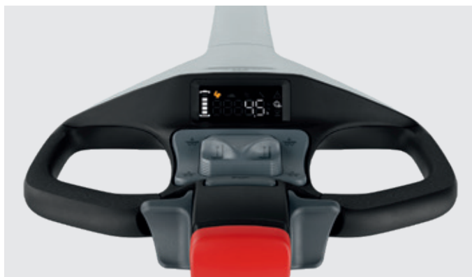
Tutte le informazioni sono immediatamente visibili sul display a LED integrato nella testa del timone
